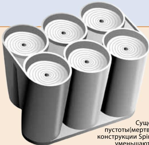
Существующие пустоты(мертвые зоны) в конструкции Spiral «6-Pack» уменьшают емкость и мощность аккумулятора.
